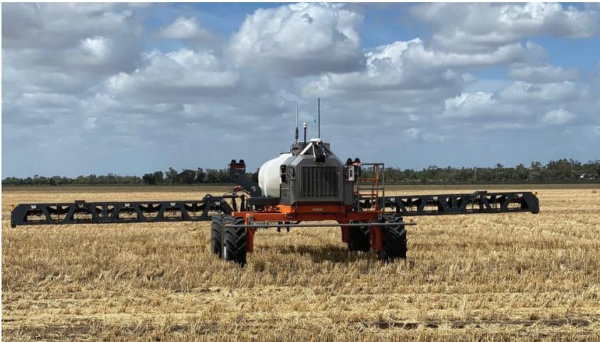
Рис. 4. Роботизированная платформа для внесения химических средств защиты растений и жидких минеральных удобрений
