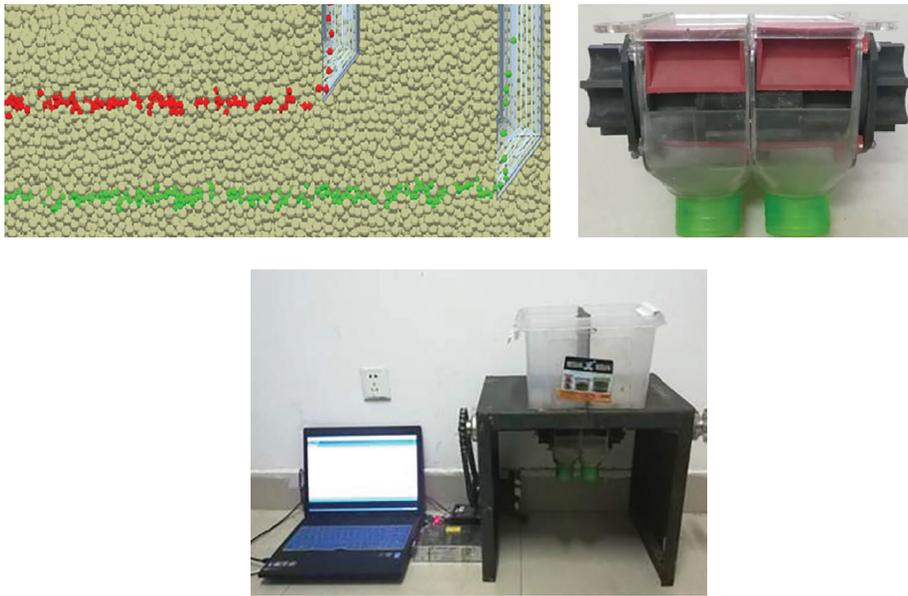
Рис. 4. Компьютерная модель и экспериментальная установка для исследования процесса внутрисочвенного внесения удобрений [12]
