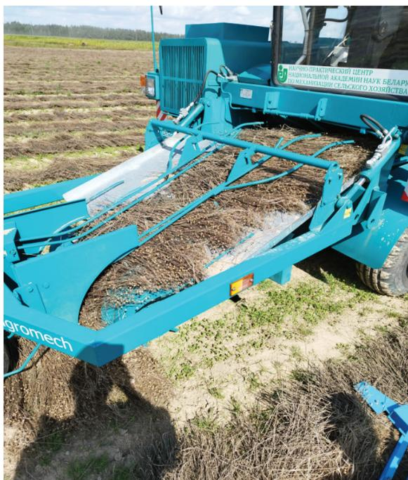
Рис. 4. Прессование льнотресты без макетного образца УФПЛ
