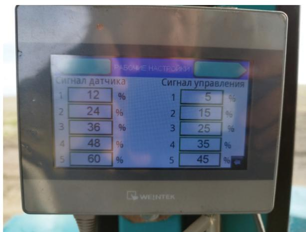
Рис. 3. Настройки программируемой панели макетного образца УФПЛ
