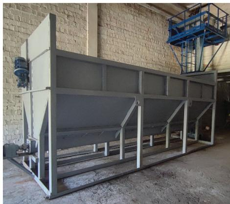
Рис. 1. Комплект оборудования для производства легкоусвояемого комбикорма для крупного рогатого скота различных половозрастных групп КОБК-1,5 после монтажа
