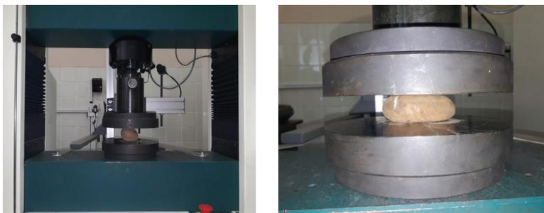
Рис. 2. Вид клубня картофеля при испытании на сжатие
