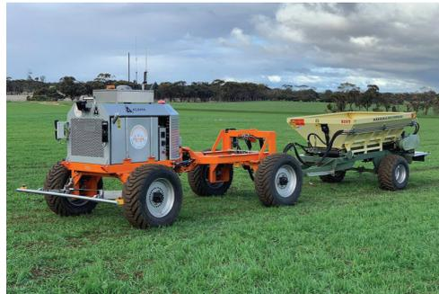
Рис. 3. Роботизированные платформы для внесения твердых минеральных удобрений
