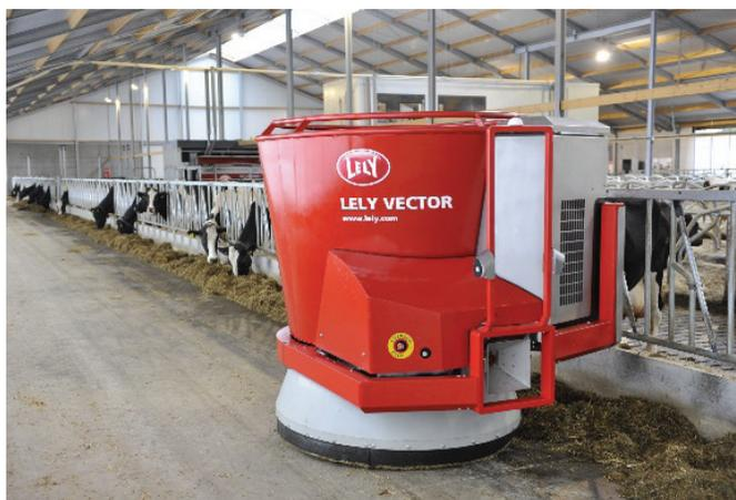
Рис. 4. Роботизированная система кормления животных
