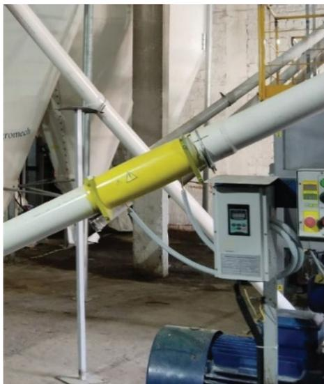
Рис. 2. Система воздействия электромагнитным полем на корм
