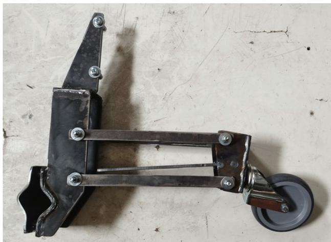
Рис. 1. Конструкция устройства контроля плотности льнотресты
