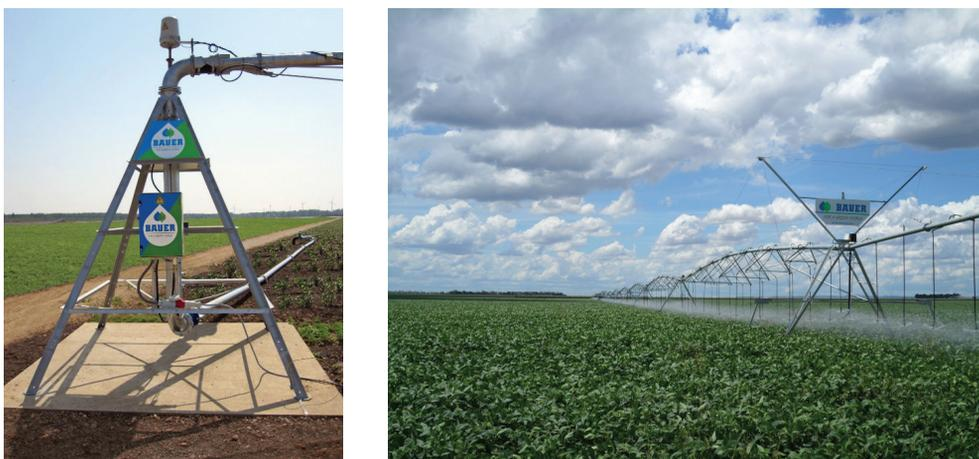
Рис. 1. Дождевальная машина кругового типа Centerstar 9000, фирмы Bauer
