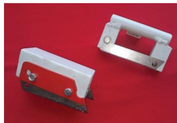
Рис. 4. Инструмент для нарезки клубней картофеля на фрагменты
