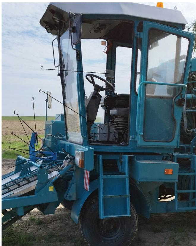
Рис. 2. Устройство формирования плотности льнотресты установленное пресс-подборщике ПЛС-1: 1 – кронштейны; 2 – прижим; 3 – тяги; 4 – опорное колесо; 5 – линейный потенциометр; 6 – программируемая панель; 7 – модуль аналогового вывода
