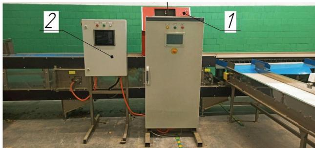
Рис. 1. Система технического зрения: 1 – оптический модуль с видеокамерой и структурной подсветкой; 2 – электронный блок управления
