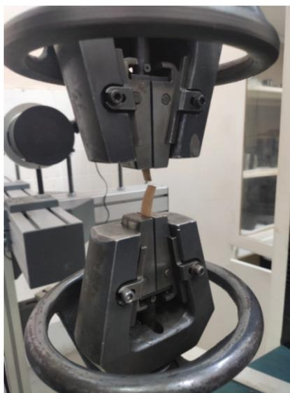
Рис. 5. Испытание на разрыв кожуры картофеля
